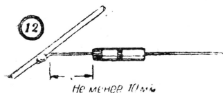
Рис. 12. Длина выводного провода до места пайки должна быть не менее 10 мм
